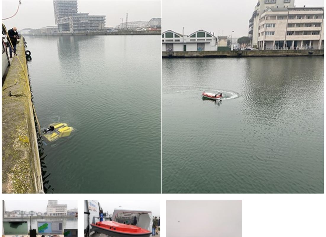
**18 Dicembre 2020** Droni marini per aggiornare le rilevazioni batimetriche e l'analisi strutturale delle banchine nel porto di Ravenna, in particolare anche per quelle zone del Canale dove è particolarmente difficile arrivare con una imbarcazione tradizionale.
